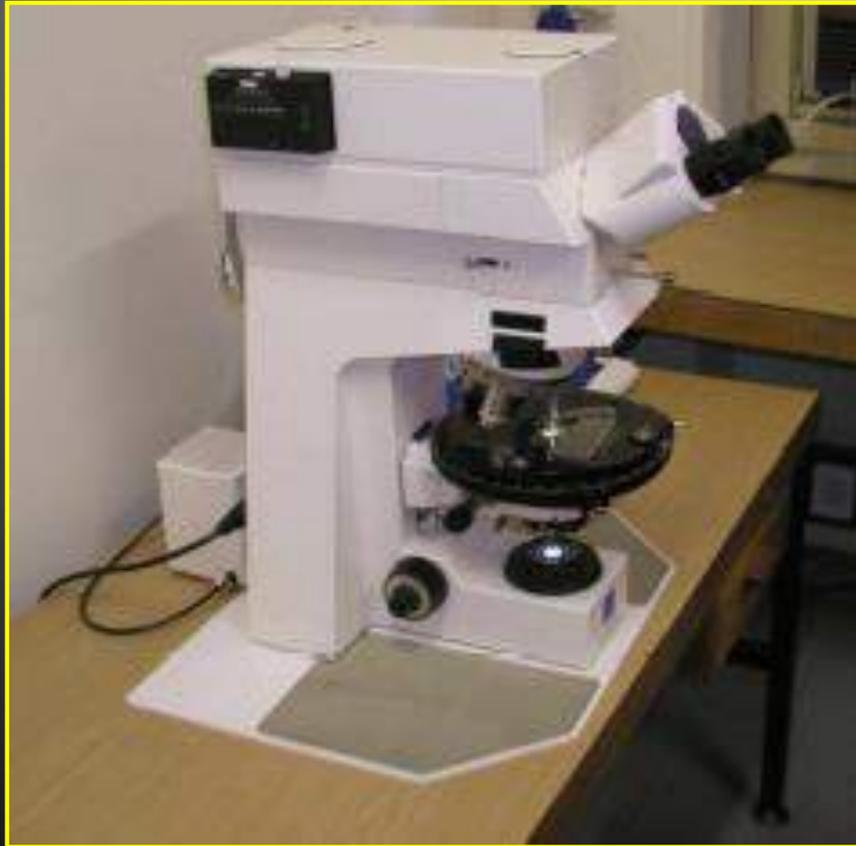
Il microscopio ottico polarizzatore, detto anche da mineralogia, deve assolvere alla duplice funzione di fornire un'immagine ingrandita del preparato, che permetta di studiarne i particolari invisibili ad occhio nudo, e di consentire l'esame delle caratteristiche (quali ad esempio colore, piano di vibrazione, ecc.) dei raggi che hanno attraversato il cristallo in esame.
