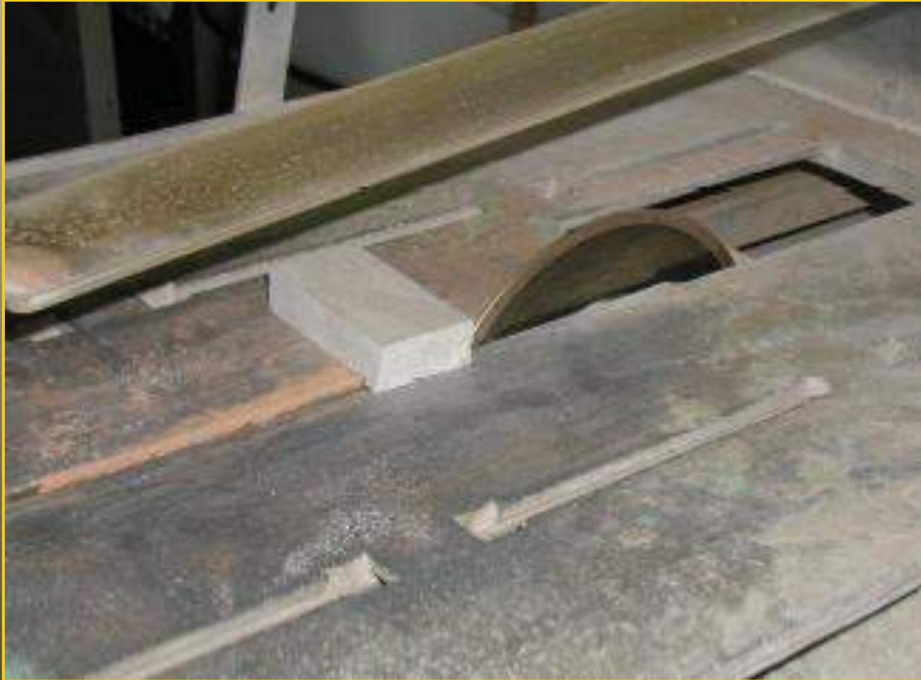
IL CAMPIONE VIENE ULTERIORMENTE RIDOTTO DI DIMENSIONI TRAMITE TAGLIO CON SEGA CIRCOLARE DIAMANTATA DI DIAMETRO PIU' PICCOLO RISPETTO ALLA PRECEDENTE
